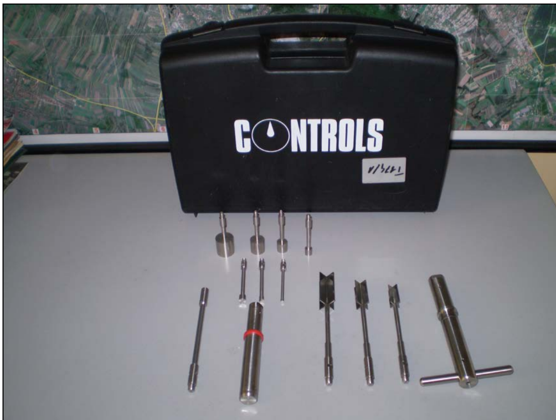
Sl.br. 2 depni penetrometar i krilna sonda „CONTROLS T-174/a
